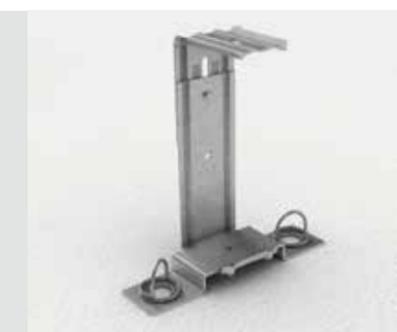
El accesorio Connect Pieza helicoidal p/ descolgar Solo está perforado. Esto le permite instalar paneles Solo a distintos niveles, aumentando la superficie absorbente en los casos en los que la altura del techo sea elevada. Únicamente tiene que pasar el cable a través de la pieza helicoidal y fijarlo en el panel inferior mediante el Connect Pieza de cuelgue.
